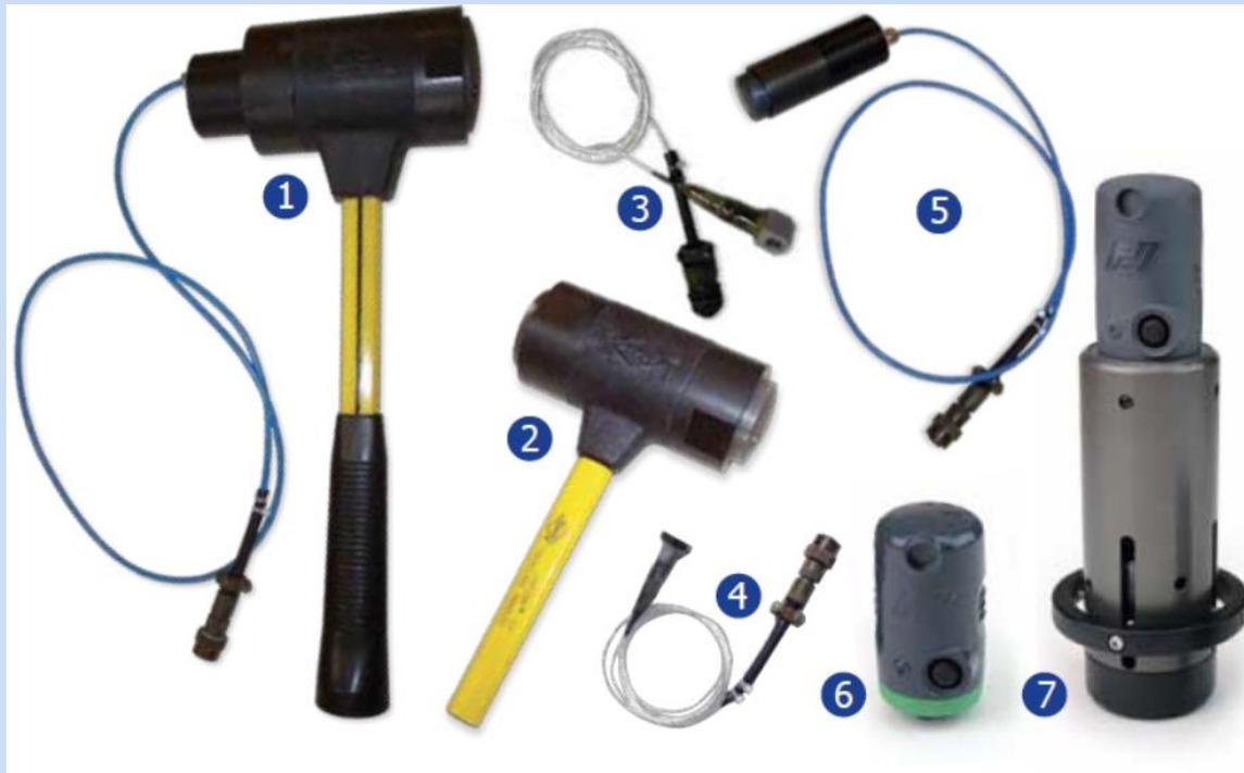
Os acessórios do PIT incluem martelos de mão em vários tamanhos, instrumentados ou não. Os martelos instrumentados podem ser tradicionais (com cabos) ou sem fio (o modelo sem fio tem um único tamanho). Os acelerômetros para uso com o PIT são projetados para acoplagem na cabeça ou no lado da estaca, e podem também ser tradicionais ou sem fio (o modelo sem fio é para acoplagem somente na cabeça da estaca).
